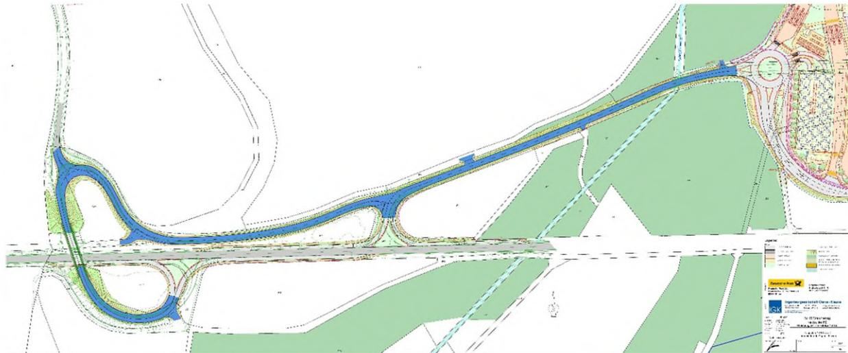
Abb. 13 Abschnitt mit offenporigem Asphalt auf KR ND 18
