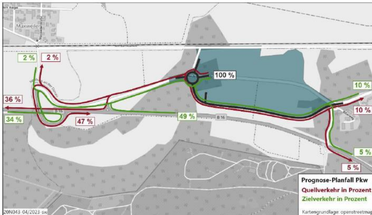
Bild 5: Aufteilung der Zufahrtsrichtungen der Pkw-Verkehre im Quell- und Zielverkehr für den Prognose-Planfall 2035 (Quelle: eigene Darstellung; Kartengrundlage: OpenStreetMap und Mitwirkende, CC-BY-SA)
