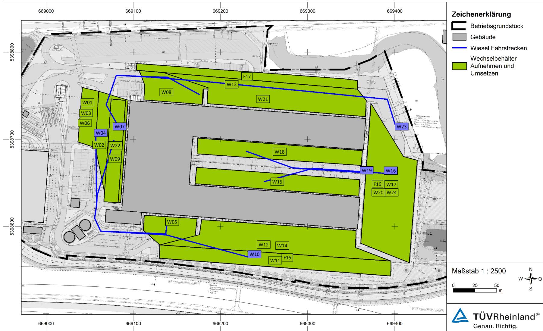
Abbildung A 2.2: Lage und Bezeichnung der wesentlichen Schallquellen (Rangierfahrzeuge)
