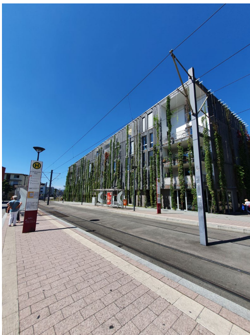
Verschiedene Kletterpflanzen in frisch gepflegtem Zustand an vertikalen Rankseilen als Kletterhilfe
